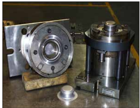
不锈钢泵壳体的成型模具。照片由丹麦Grundfos A/S 提供。
