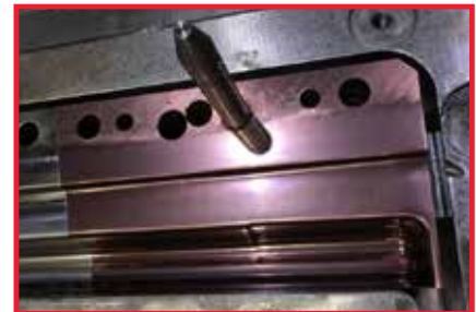
Caldie + Duplex-VARIANTIC 1000 无明显磨损。 1)
