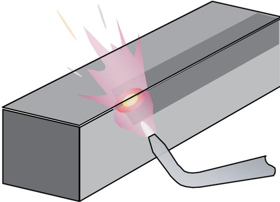
焼入れする表面をガスの炎で連続的に850°C付近まで加熱し、その後大気冷却します。通常は、酸素-アセチレン炎が使用されます。数秒で加熱ができるように口径の大きさや炎の温度を調整します。
