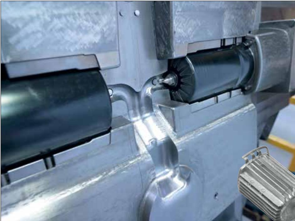
带有流道、浇口、溢流的铝泵壳压铸件
