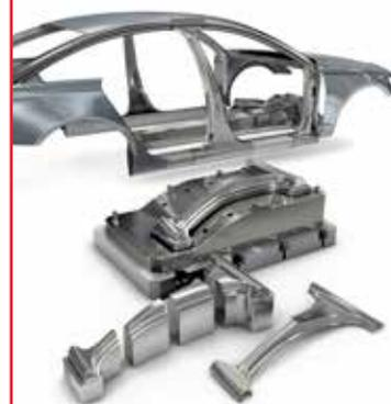
窒化後にPVDタイプのコーティングを施すと、耐引掻き摩耗と耐コーリング性を向上させることができます。
