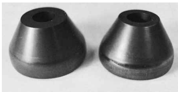
ASSAB PM 23 SuperClean にPVD 処理した冷間造管工具
