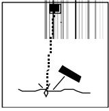
集束させた電子ビームで表面を走査します。高エネルギー電子は、表面から数nmから数 $\mu\text{m}$ の範囲の原子に作用し、拡散が起こります。初期の電子はエネルギーを失ったり、方向を変えたりします。
