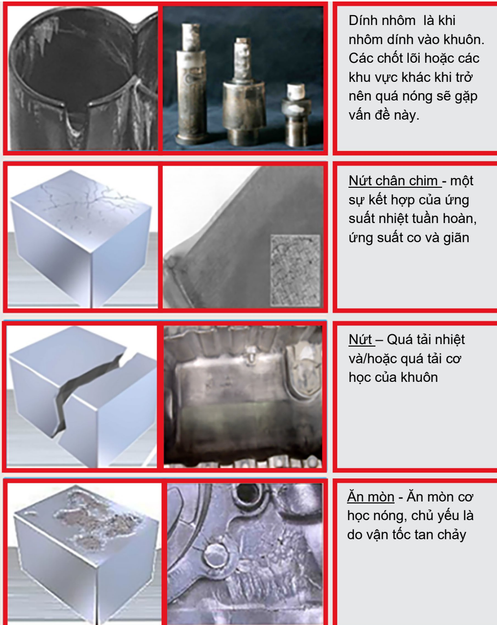
Hình. 2 Ảnh minh họa các lỗi hư hỏng phổ biến nhất trong HPDC
